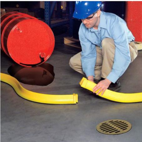
*Un derrame se contiene asegurando el área para evitar que la escorrentía llege al drenaje (storm drain).*
