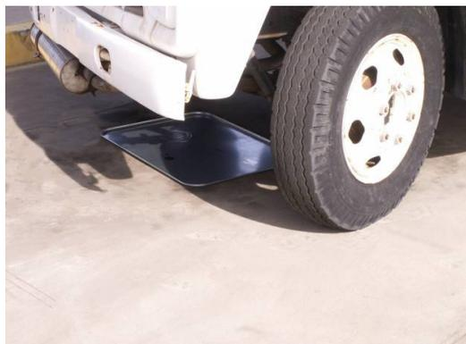
*Se coloca una bandeja de goteo temporal debajo de un vehículo.*
